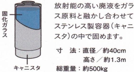
図 1. ガラス固化体の構造
