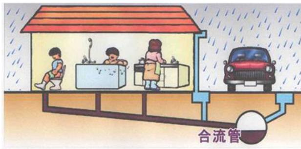
図 1. 合流式の下水集水方法
