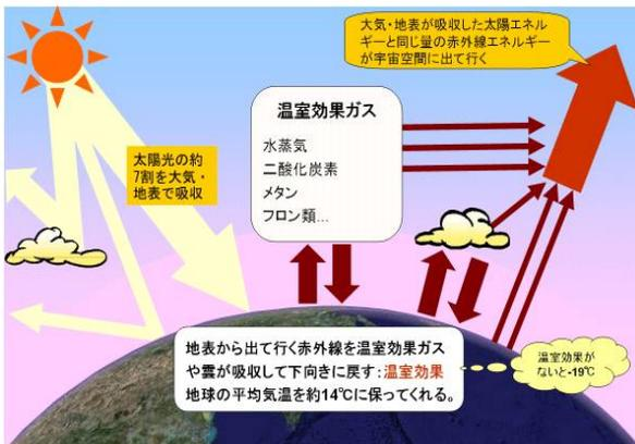
図 4. 地球温暖化のメカニズム (気象庁資料)
