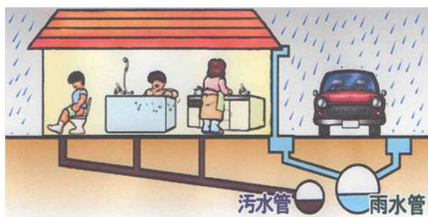
図 2. 分流式の下水集水方法
