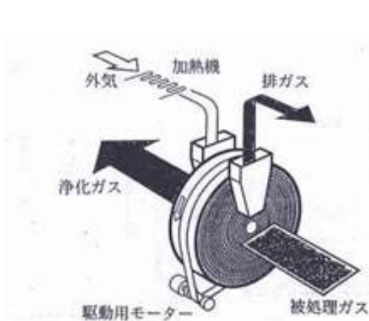
図 2. ハニカム型連続回転式吸着装置
